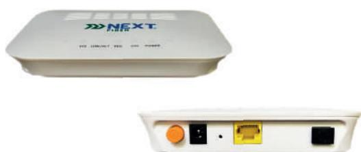
A ONU Híbrida GPON/EPON da Next Fiber vem equipada com chip da Realtek, possui taxas de carregamento de 1.25Gbps para upstream e 2.5Gbps para downstream, com comprimento de ondas entre 1310nm e 1490nm.
